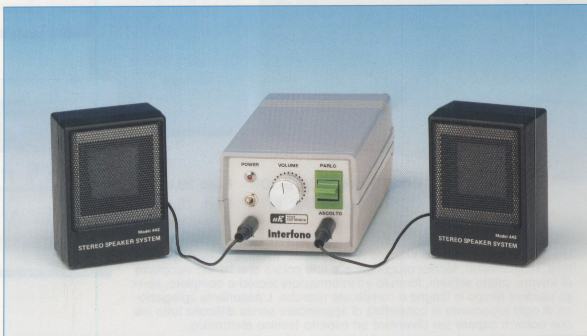
Fig.1 L'interfono è composto da un piccolo amplificatore racchiuso in un mobiletto plastico. Per trasferire il parlato dalla Cassa Acustica di sinistra a quella di destra o viceversa dovrete solo spostare la leva del deviatore S1 posta sul lato destro del pannello. Se agendo sull'interruttore «power» non vedrete accendersi il diodo led presente sul pannello, l'interfono non potrà funzionare. Se riscontrate questo inconveniente, leggete il paragrafo «realizzazione pratica».
