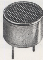
Fig.8 La capsula Ricevente RX presenta stampigliata sul retro la sigla 400SR. Altre scritte che potrebbero apparire sotto 400SR non sono significative.
